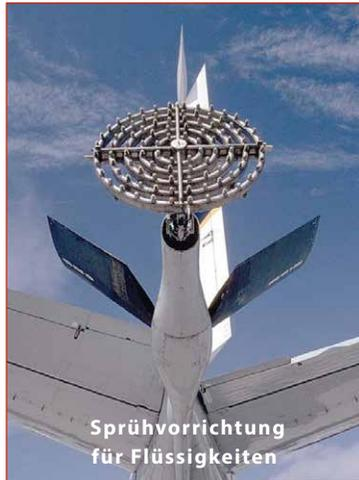
Sprühvorrichtung für Flüssigkeiten
